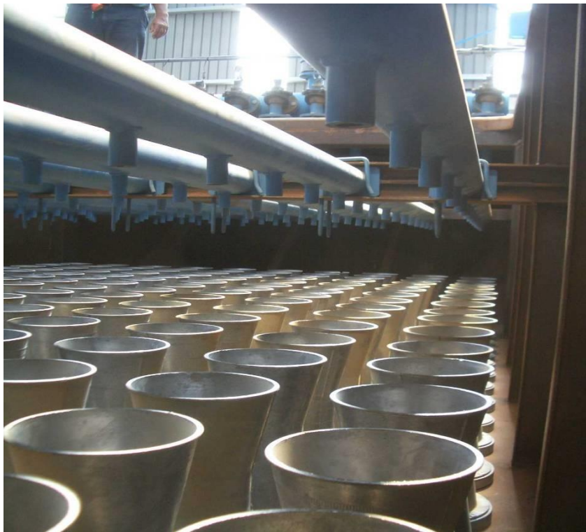
Рисунок 2.6.5 - Рукавный фильтр (вид изнутри)
