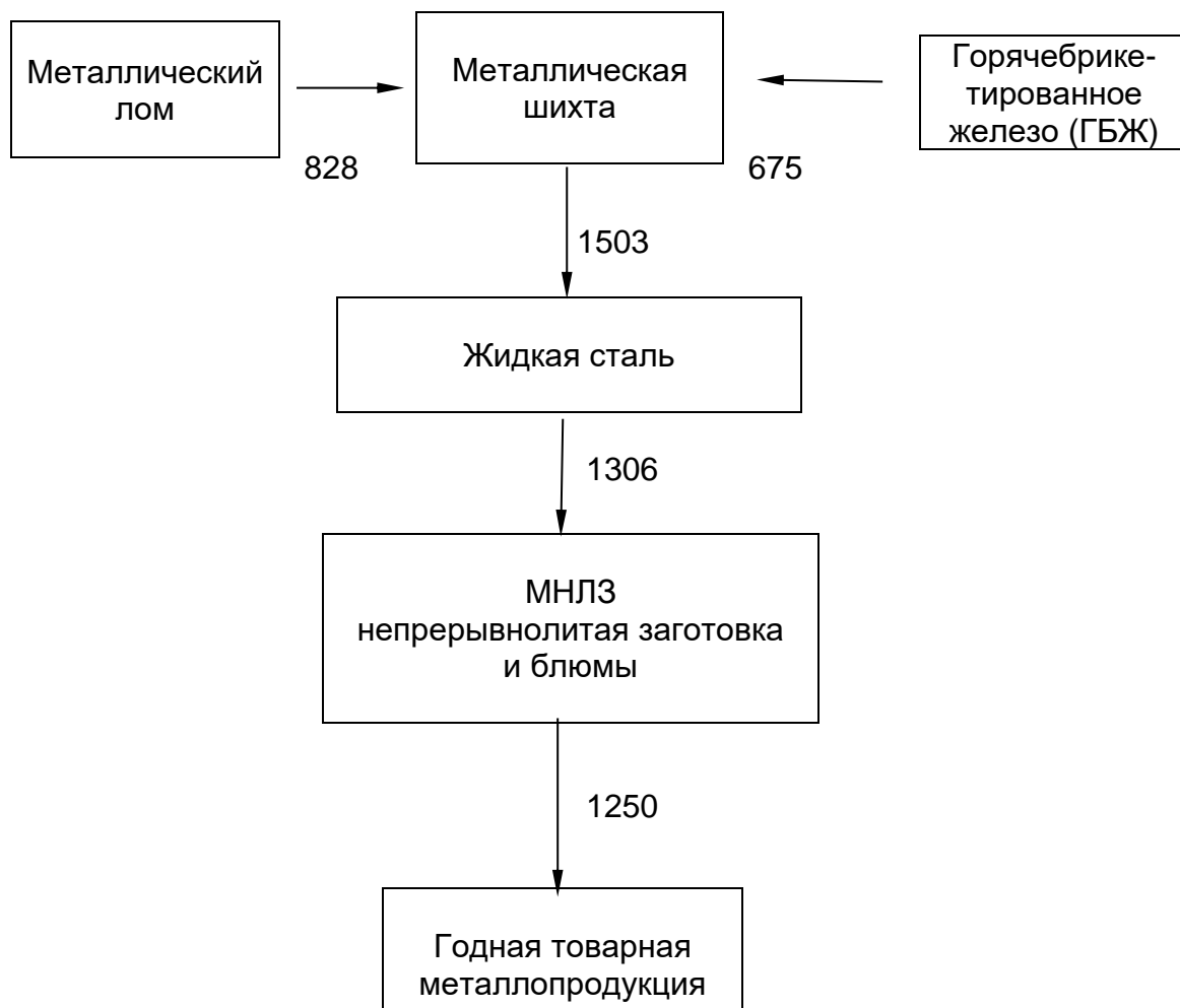
Рисунок 1.1.1 – Схема движения металла, тыс. т в год
